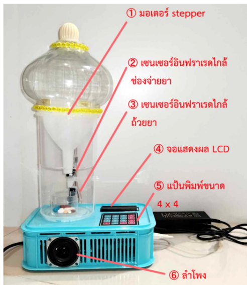
ภาพที่ 2 ภาพและแผนภาพวงจรอุปกรณ์แจ้งเตือนการรับประทานยาประจำบ้านสำหรับผู้สูงอายุ
