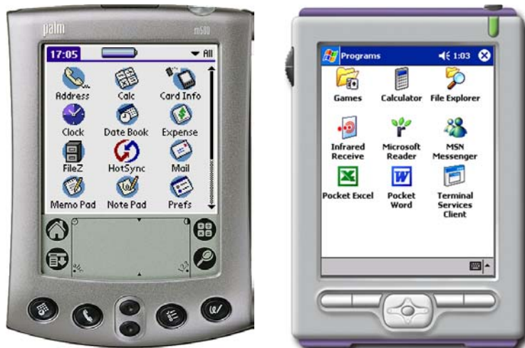
รูปที่ 1 (ซ้าย) พีดีเอที่ใช้ระบบปฏิบัติการ PalmOS ซึ่งโดยทั่วไปเรียกว่าเครื่องปาล์ม (ขวา) พีดีเอที่ใช้ระบบปฏิบัติการ Microsoft Windows CE หรือ Microsoft Pocket PC ซึ่งโดยทั่วไปเรียกว่าเครื่องพ็อกเก็ตพีซี
