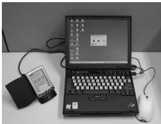
รูปที่ 4. การเชื่อมต่อปาล์มกับเครื่องคอมพิวเตอร์ผ่านทาง USB โดยใช้แท่นเสียบอุปกรณ์
