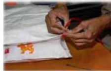
ใช้สีกองเก็บกระสอบทั้ง 2 ใบ บริเวณมุมด้านข้างทั้ง 2 ด้าน
